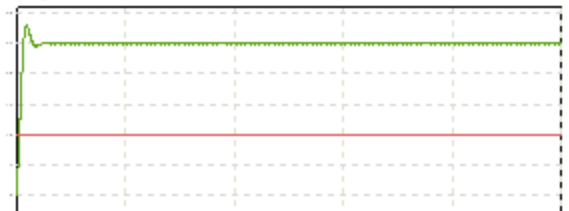
图6 d=0.2时 (1) 输出电压 50V 和 (2) 输入电压 20V 波形
